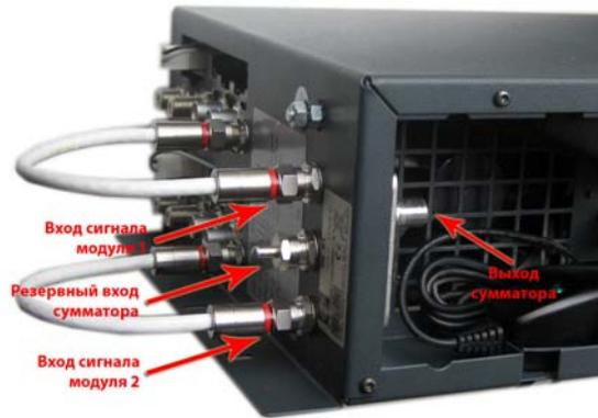
*Рисунок 16. Вид на шасси GN01 снизу со стороны сумматора.*
