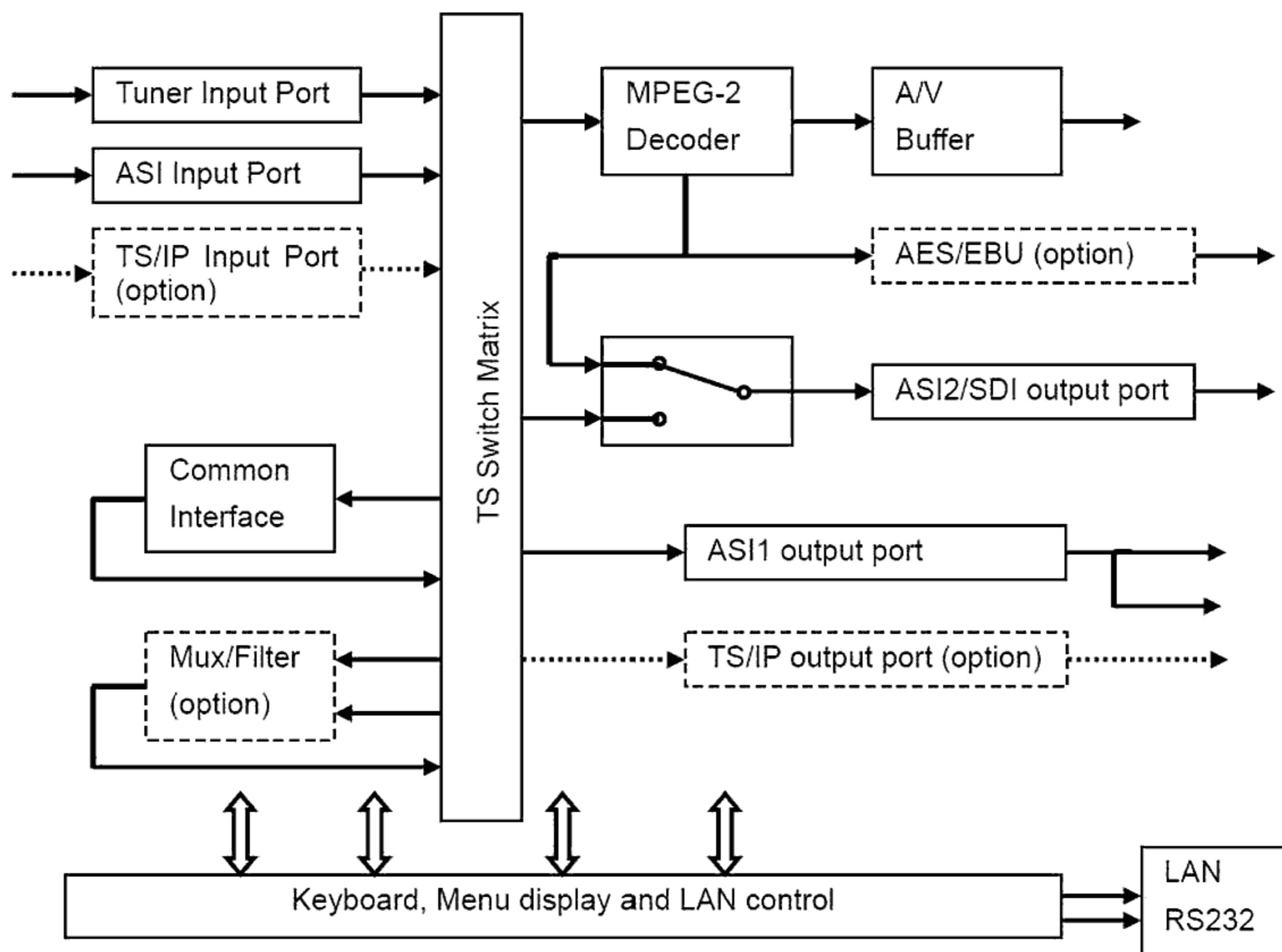
Рис. 6.1. Функциональная блок-схема DSR-4000CI-\*\*S2
