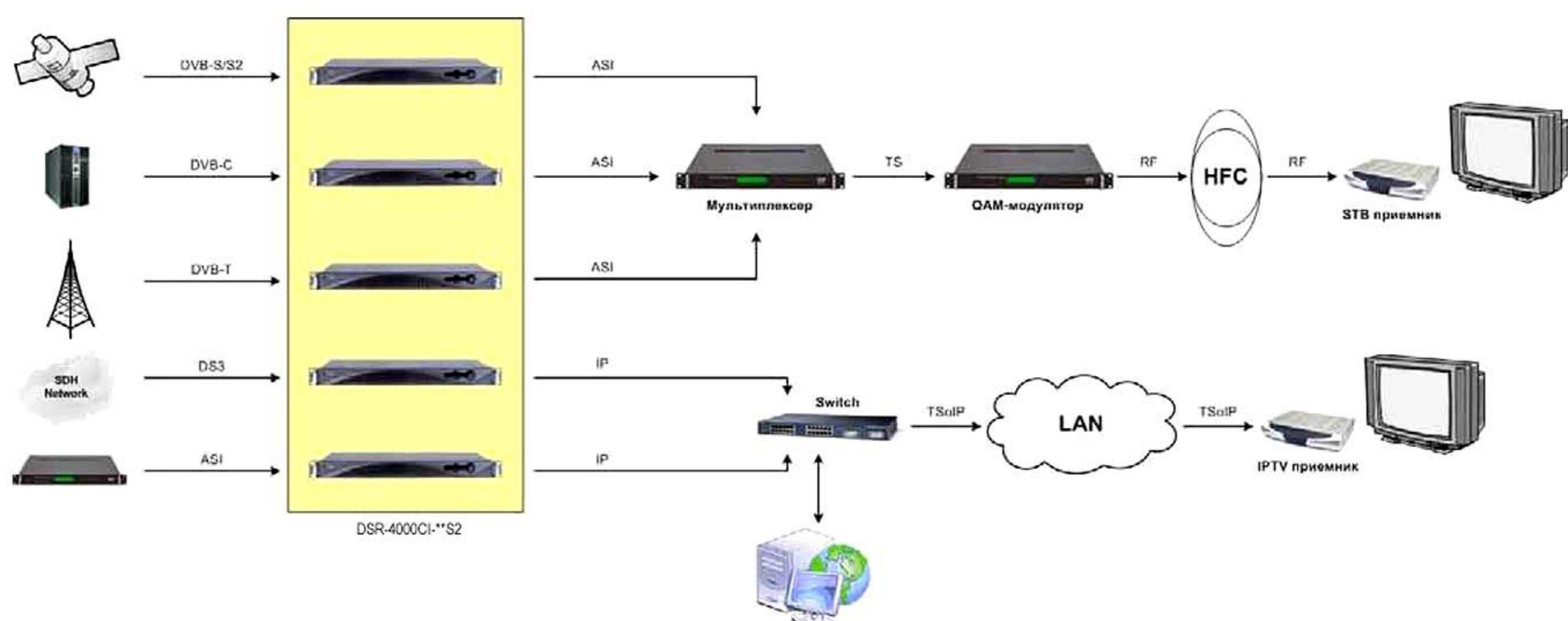
Рис. 2.1. Схема применения DSR-4000CI-\*\*S2
