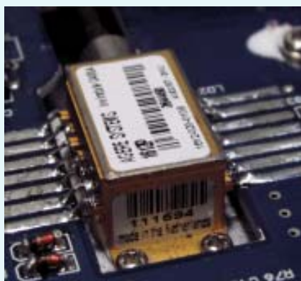
Фото 3.2. Цифровой лазер JDS Uniphase 2.5 мВт доживает свою жизнь в китайском аналоговом оптическом передатчике под фальсифицированной маркой AGERE SYSTEMS. Работа идёт на запредельной выходной мощности 6.8 мВт (!!!).
