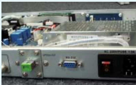
Фото 2.3. Интерфейсный разъем RS 232: установлен, но не подсоединён изнутри!! (см. Фото 2.4)
