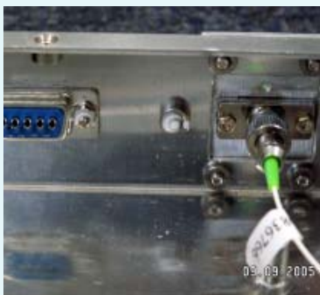
Фото 2.4. Вид на интерфейс RS 232 изнутри
