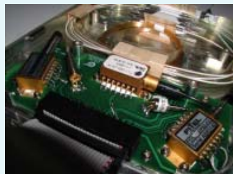
Фото 5.1. Вид сверху на усилительный блок. Видны разномастные лазеры накачки: FTEL, SDL, Sumitomo. Очевидно, ставились те, которые удалось «добыть»... Также на переднем плане два разнородных фотодиода.
