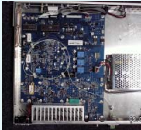
Фото 2.1. Китайский передатчик 1550 нм со снятой верхней крышкой (общий вид)
